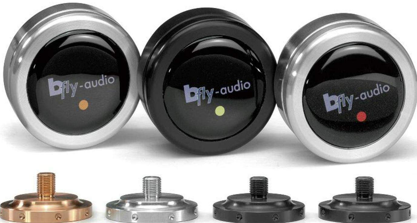
Die PolarX stehen auf Gelpads. Farbige Punkte markieren die maximale Belastbarkeit, Orange steht beispielsweise für „bis 10 Kilogramm“. Die darunter abgebildeten Conductoren nehmen flächig Kontakt zum Geräteboden auf und sind über ein Feingewinde höhenverstellbar. Sowohl die Standardversion aus Aluminium als auch die Kupfer-Variante wird immer mit einem zusätzlichen Exemplar aus POM geliefert. So lässt sich der Klang feinfühlig justieren
