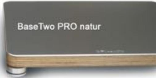
Das Erfolgsmodell **BaseTwo** sowie die **PowerBase** hat als Oberfläche eine eloxierte Aluminiumplatte, die nicht nur gut aussieht. Die spiralförmige, weiche Polymer-Verklebung wirkt absorbierend, während die 3mm Aluminiumplatte als Isolator fungiert. Zudem dient das Aluminium als Schirm für hochfrequente Strahlung.
