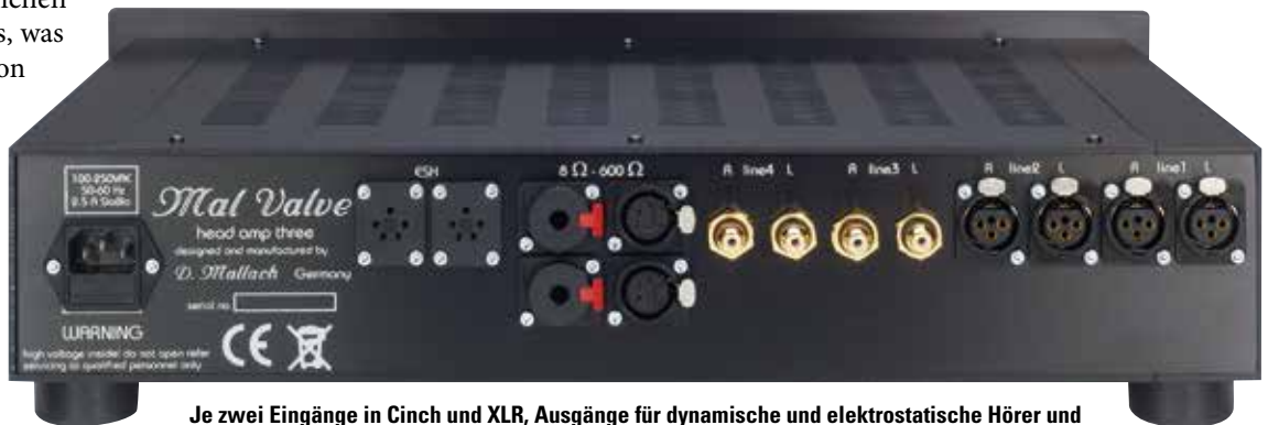
Je zwei Eingänge in Cinch und XLR, Ausgänge für dynamische und elektrostatische Hörer und symmetrische Ausgänge für magnetostatische Hörer von Audeze
